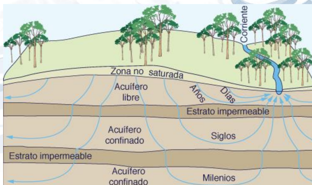
FIGURA 3.- SISTEMA DE FLUJOS EN ACUÍFEROS
